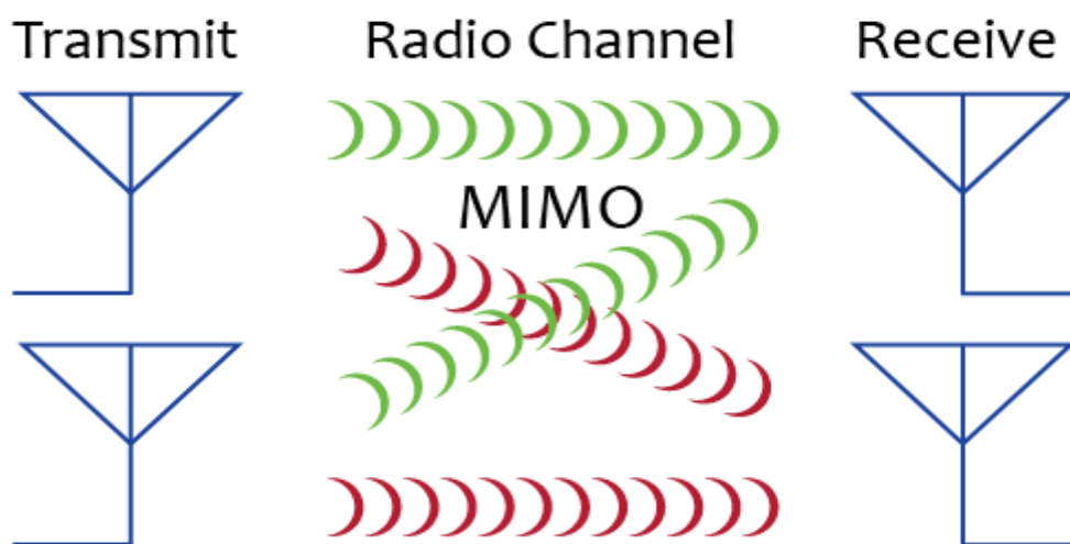
Рис. 3.31. Принцип Multiple Input Multiple Out
