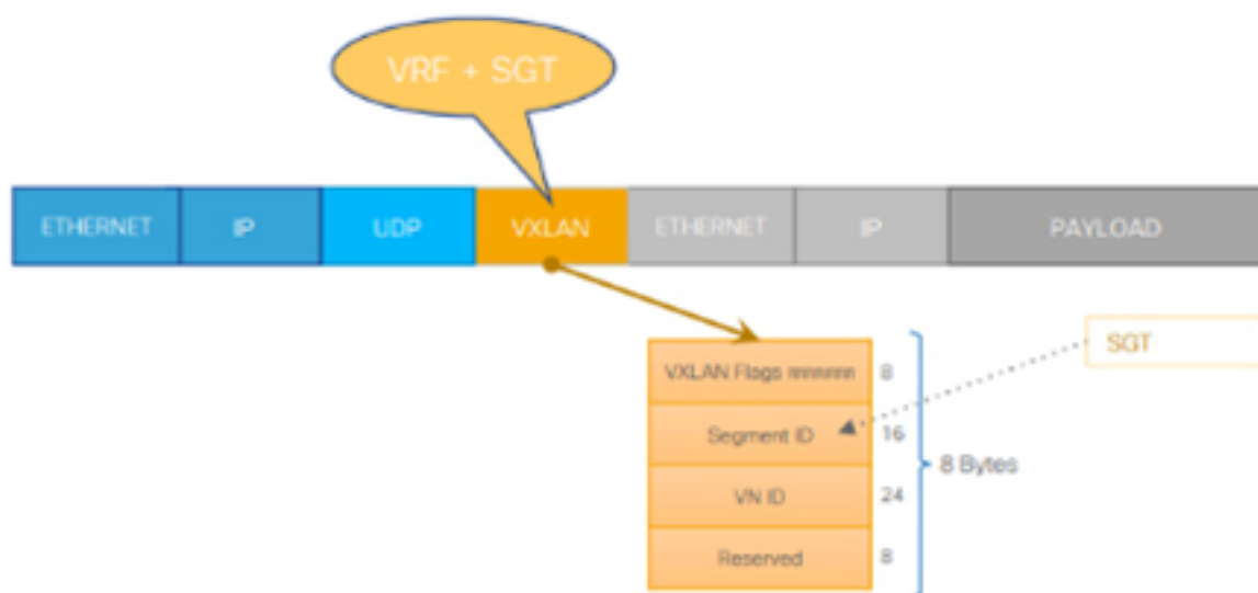
Рис. 3.46. Розміщення VN ID і SGT всередині VXLAN -заголовка
