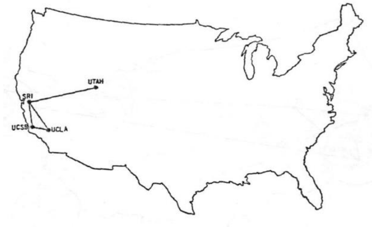
Рис. 3.17. Схема мережі ARPANet за станом 1969 р.
